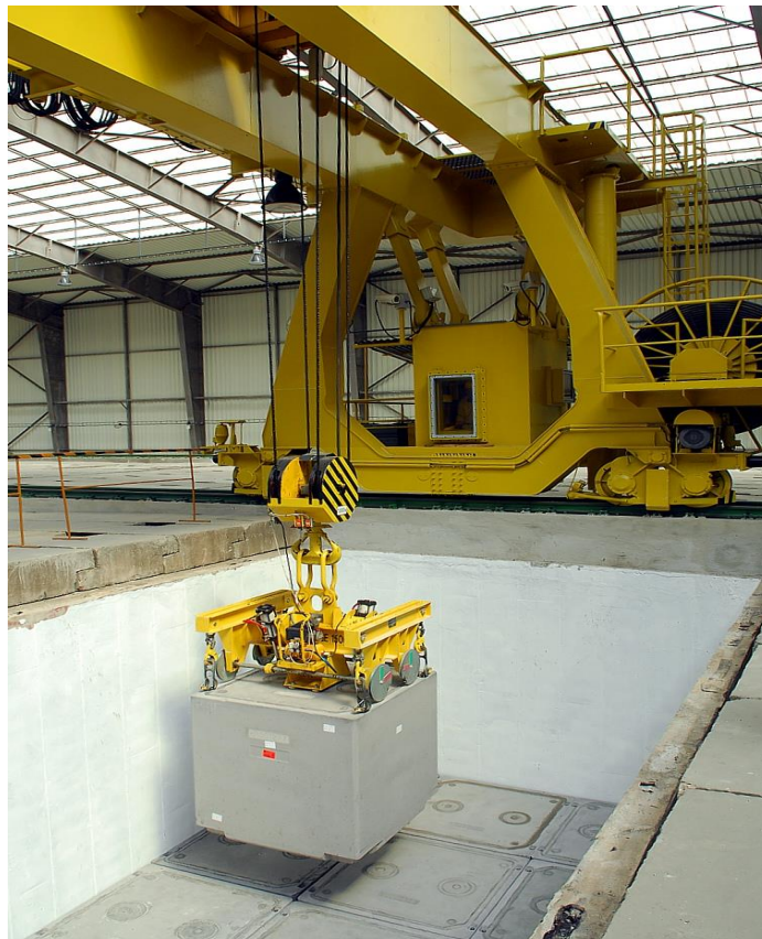
Obr. č. 21: VBK po meraní na gama skeneri pred uložením do úložných boxov úložiska v dvojrade
