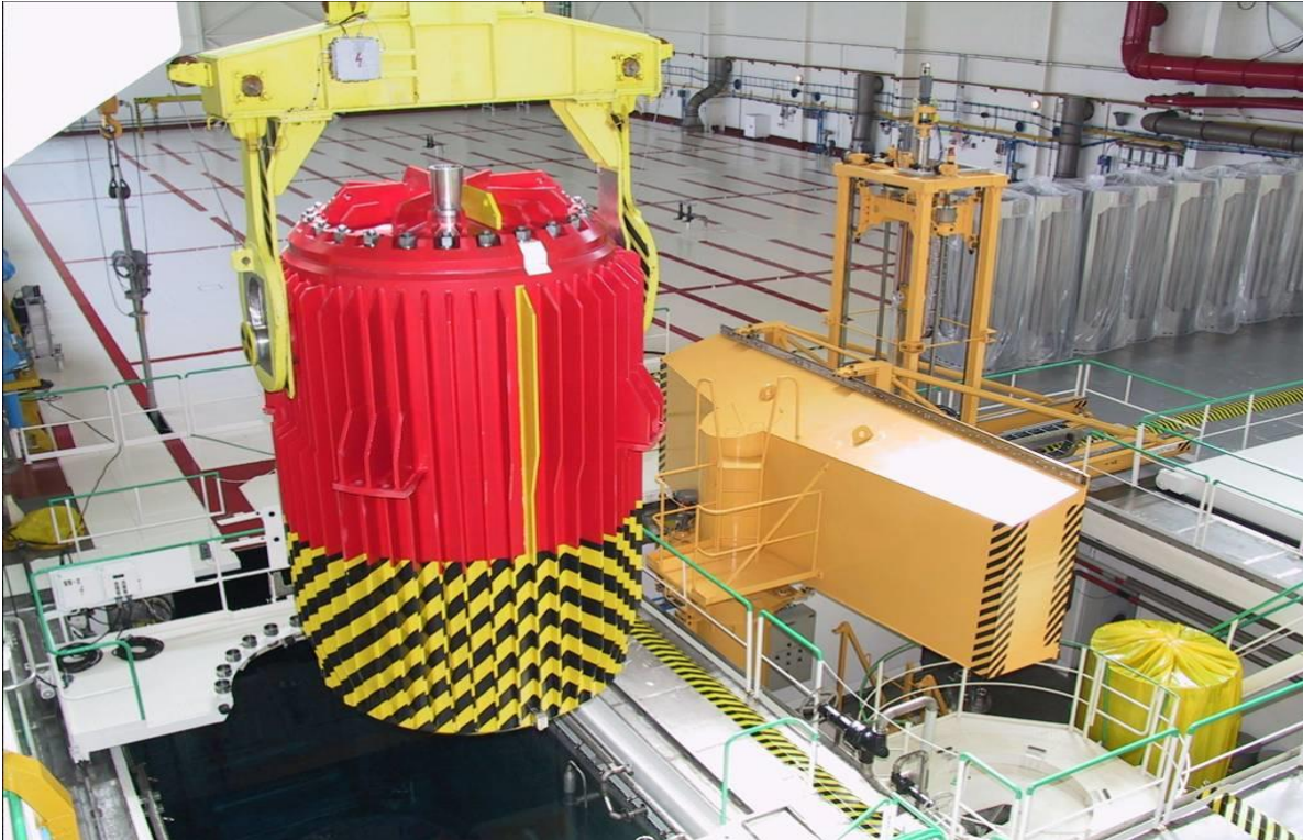
Obr. č. 14: Transport TK C-30 pomocou špeciálneho transportného závesu
