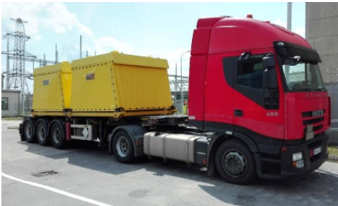
Obr. č. 6 Preprava vláknobetónových kontajnerov do RÚ RAO
