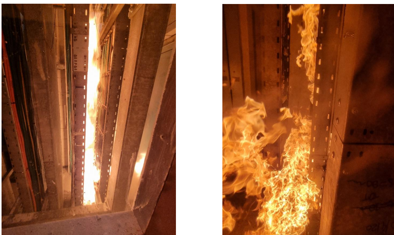
Obrázok P2-2 Skúška SHZ na vertikálnych káblových lávkach v Pavuse, Česko
