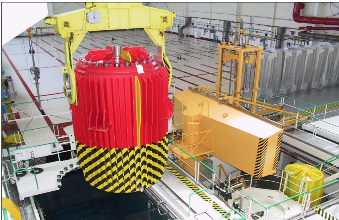
Obr. č. 13: Transport TK C-30 pomocou špeciálneho transportného závesu
