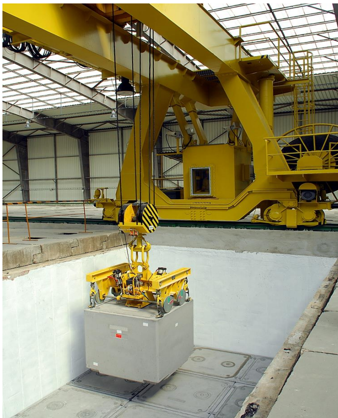
Obr. č. 19: VBK po meraní na gama skeneri pred uložením do úložných boxov úložiska v dvojrade
