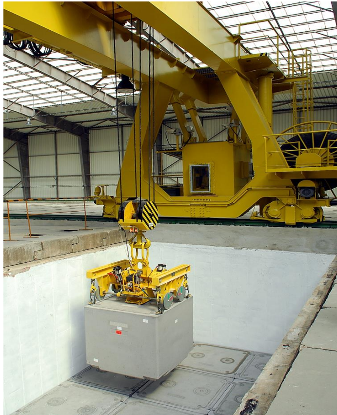
Obr. VBK po meraní na gama skeneri pred uložením do úložných boxov úložiska v dvojrade
