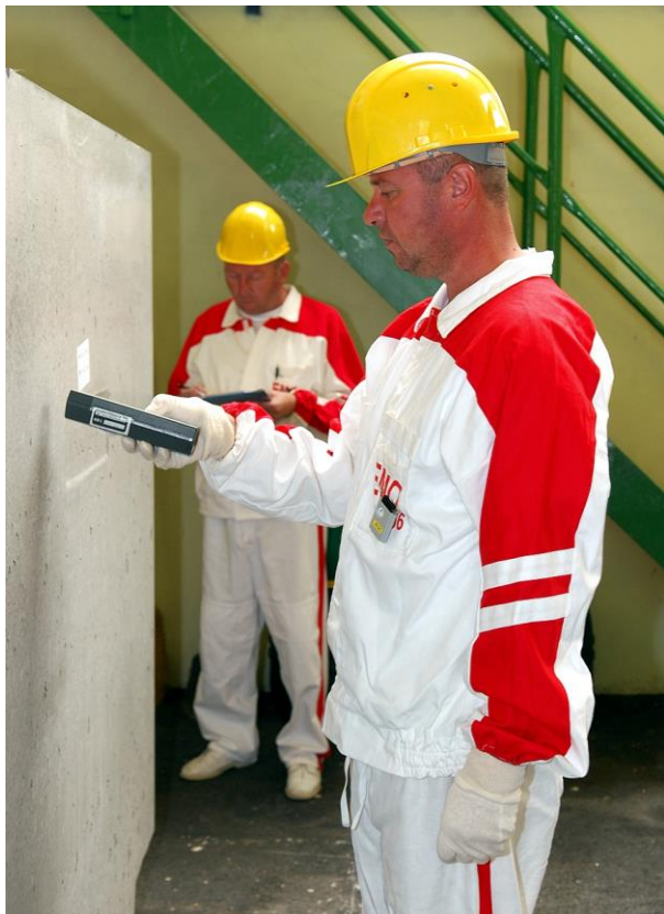
Obr. F.4.2 Monitorovanie rádioaktivity na povrchu vláknobetónových kontajnerov
