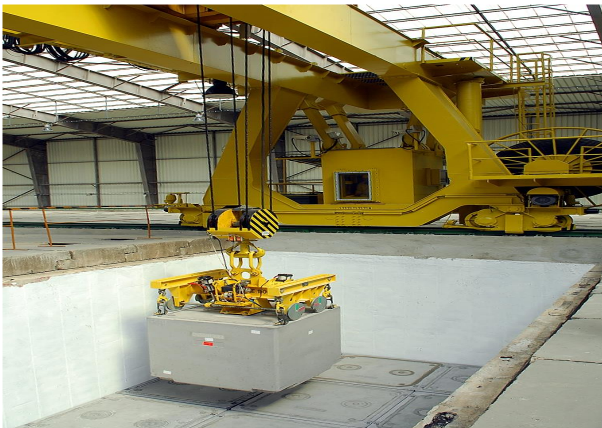
Obr. D.2.7a) VBK po meraní na gama skeneri pred uložením do úložných boxov úložiska v dvojrade
