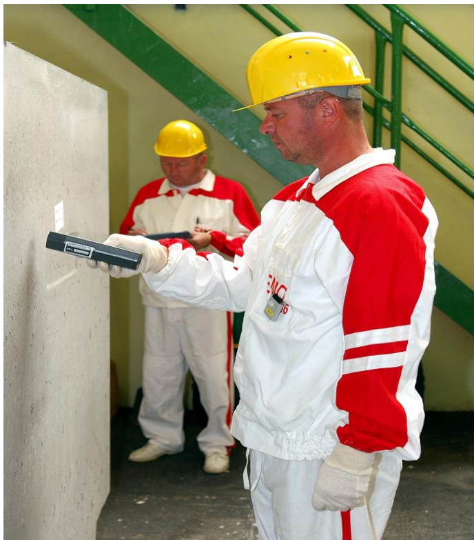
Obr. F.4.2 Monitorovanie rádioaktivity na povrchu vláknobetónových kontajnerov
